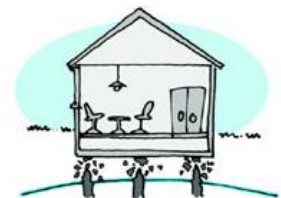
Grondwaterpeil te laag: paalrot
